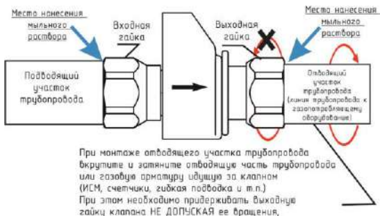
Схема 2. Порядок монтажа отводящего участка трубопровода к клапану
